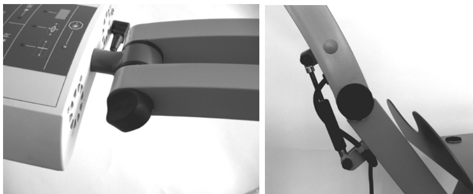
Obrázok 6-3 Otočné kolieska blokujúce skener a ramená statívu
