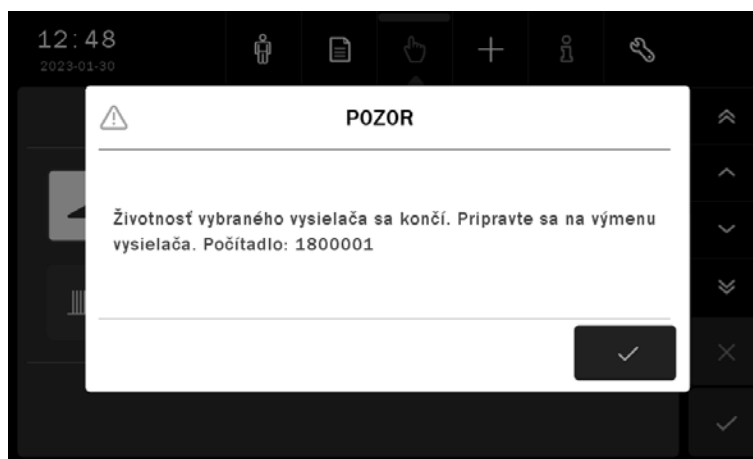
Obrázok 10-5 Obrazovka s informáciou o blížiacей sa výmene opotrebovaného vysielача
