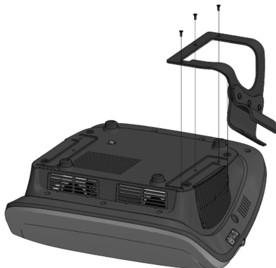
Obrázok 6-2 Montáž držiaka aplikátora
