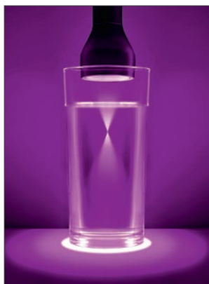
Paprsek záření přenášený přes nástavec DILA pozorovaný ve skle.
